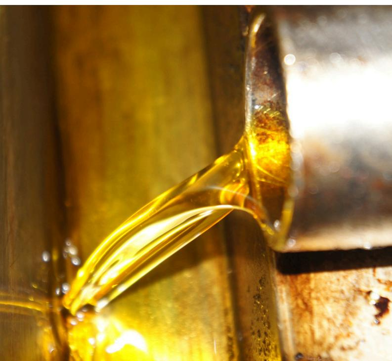
*Cire liquéfiée et épurée en sortie de cuve de fonte*
